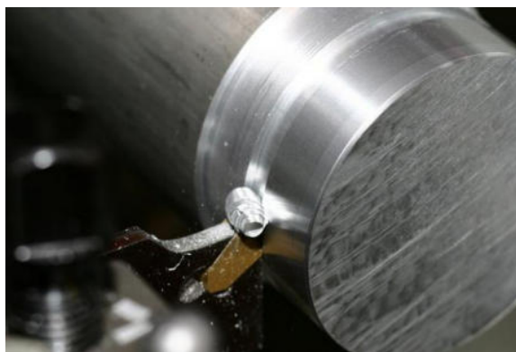
Рисунок 2 - Обработка гладкого вала на токарных станках
