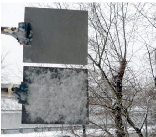
Рисунок 3 – Поверхность с гидрофобным покрытием (сверху) и без покрытия (снизу).
