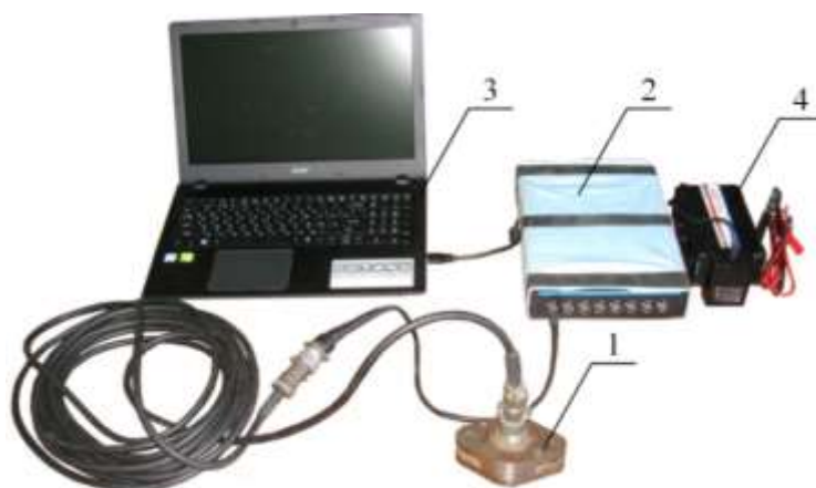
1 – тензометрическое звено; 2 – тензометрическая станция; 3 – переносной ПК; 4 –преобразователь напряжения 12-220 В
