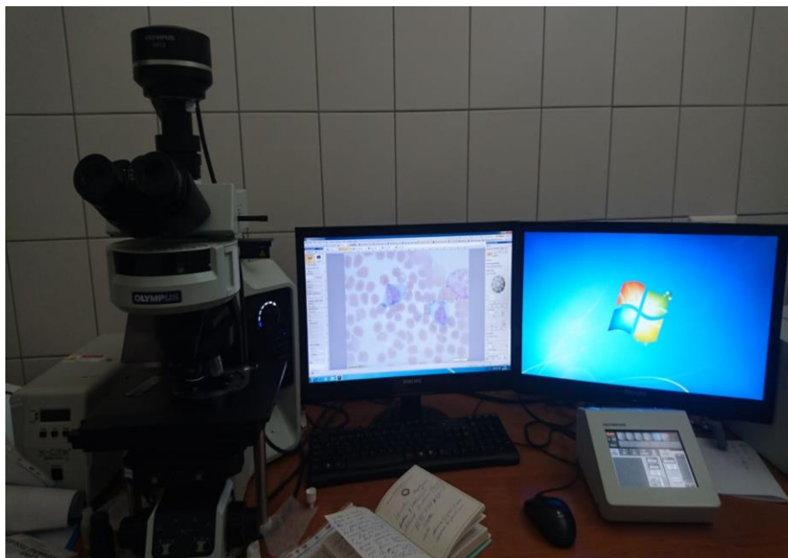
Рисунок 7 – Система для проведения морфометрии Olympus DP72
