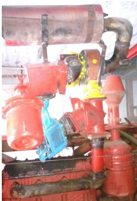
2-ші сурет – Гидроаккумуляторы бар эксперименттік зерттеулер жүргізуге арналған стенды
