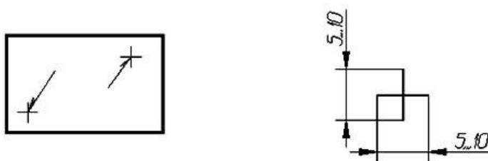
Рисунок 52 - Обозначение сварных точек
