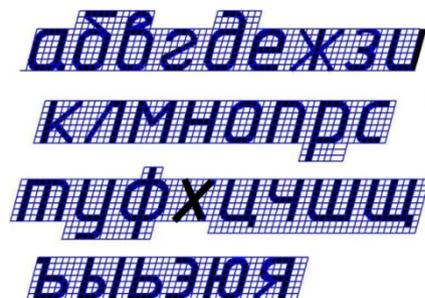
Рисунок 6 - Форма и конструкция строчных букв русского алфавита
