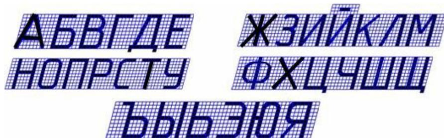
Рисунок 5 - Форма и конструкция прописных букв русского алфавита
