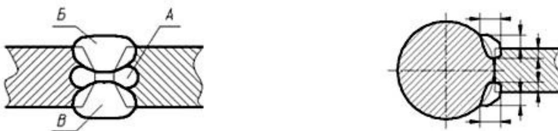
Рисунок 53 - Пример изображения нестандартного сварного шва
