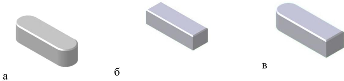
Рисунок 75—Образец призматических шпонок: а) исполнение 1; б) исполнение 2; в) исполнение 3.
