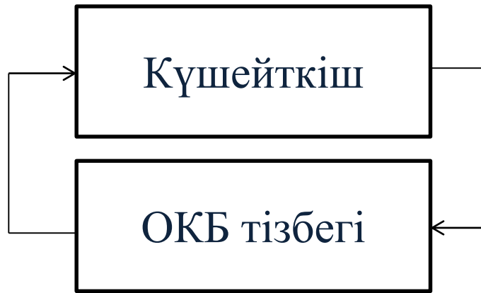
Сурет 47 – Генератордың құрылымдық схемасы
