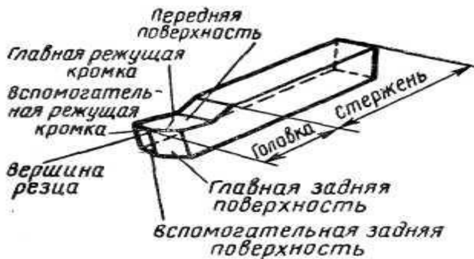
Сурет 4 - Кескіш беттері мен элементтері
