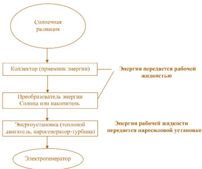
14-сурет. Күн жылу электр станциясының принципті блок-схемасы
