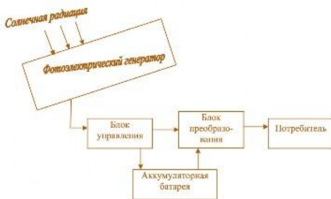
21-сурет. Күн фотоэлектрлік станциясының схемасы
