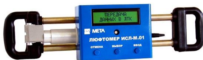
Рисунок 18 – Общий вид люфтомера [9]
