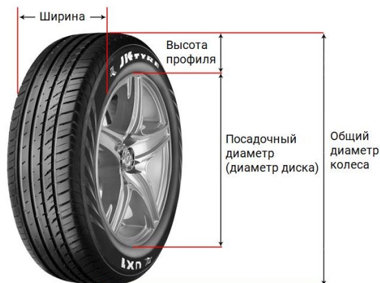
Рисунок 3 – Общий диаметр колеса автомобиля
