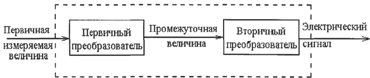
Рисунок 22 - Структурная схема комбинированного преобразователя
