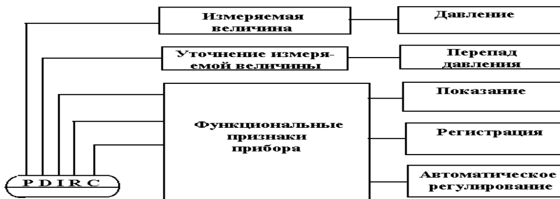
Рисунок 15 – Принцип построения условного буквенного обозначения на функциональных схемах
