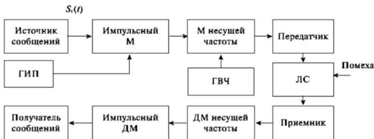
Рисунок 3 - Структурная схема импульсной системы передачи информации
