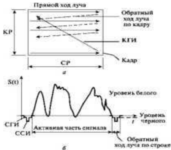
Рисунок 73 - Формирование телевизионного раstra (а) и структура видеосигнала одной строки (б)
