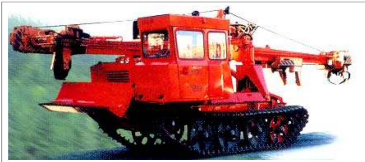
Рис. 55. Самоходная сучкорезная машина ЛП-30Г
