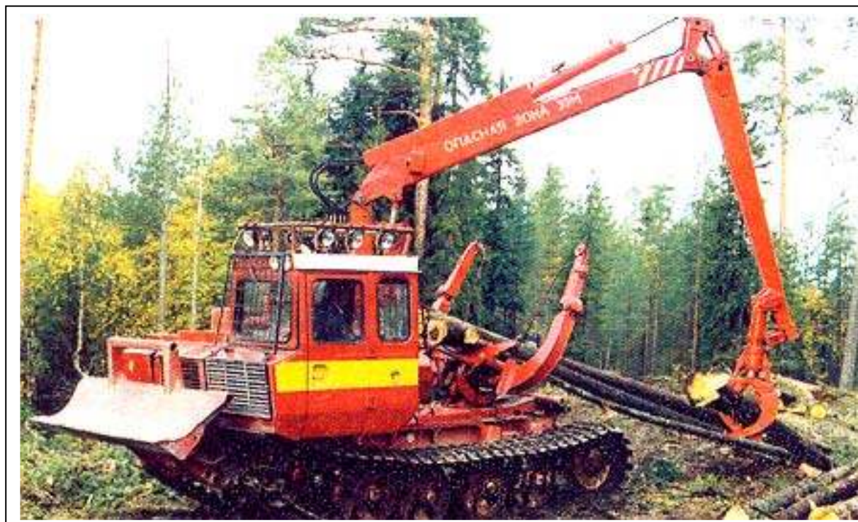
Рис. 58. Трактор для бесчokerной трелевки леса ТБ-1М-15
