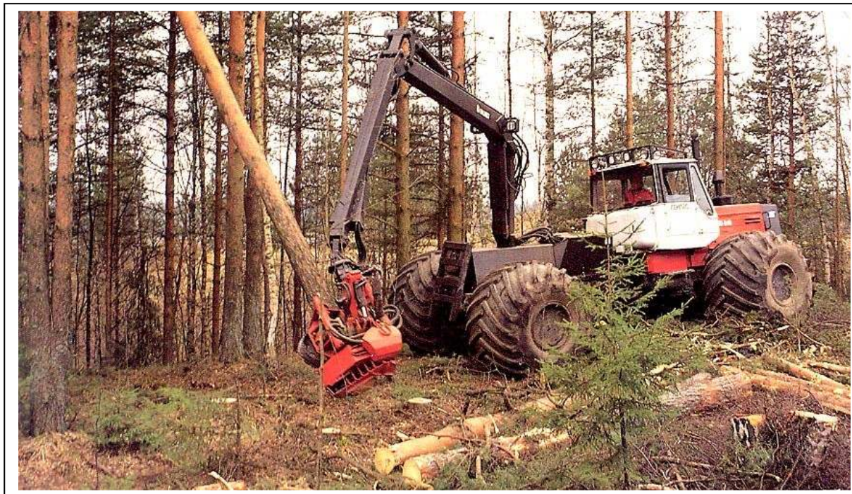
Рис. 61. Валочно-сучкорезно-раскряжевочная машина «Софит-Х»
