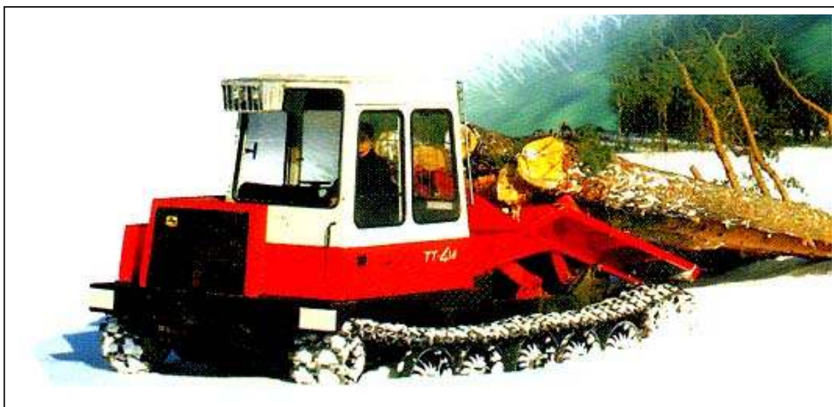
Рис. 57. Трелевочный трактор ТТ-4М
