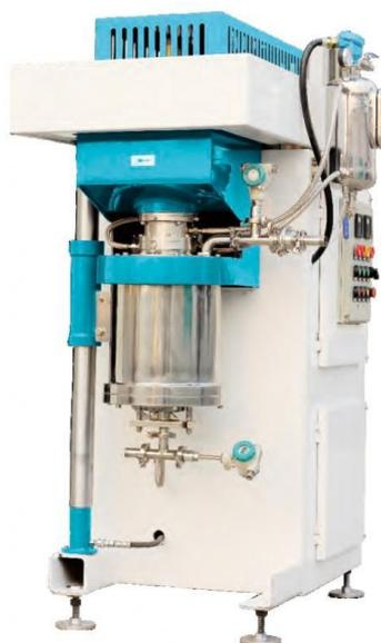
Рисунок 5 - Бисерная мельница Russa M с "пальцевым" типом ротора
