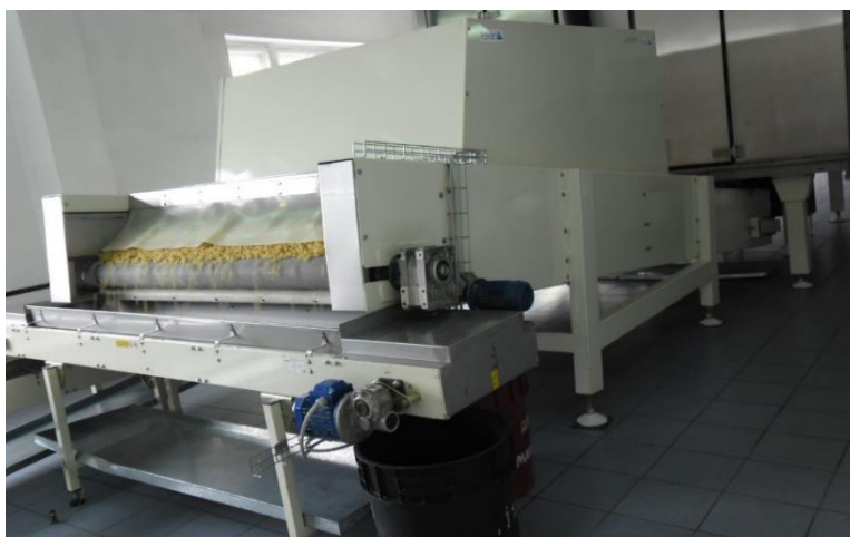
Рисунок 11 – Ленточный охладитель СВВ 160/8250
