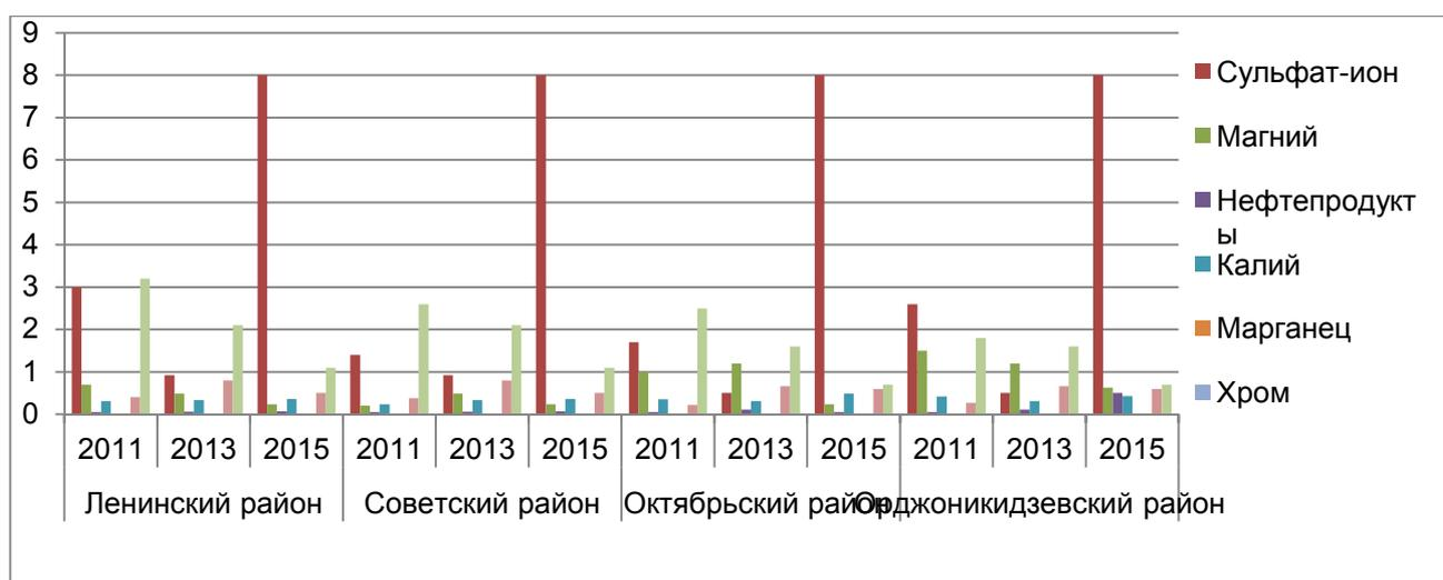
Рисунок 4 Концентрации загрязняющих веществ в фоновой пробе снега в диапазоне 0-9,0 мг/дм<sup>3</sup>
