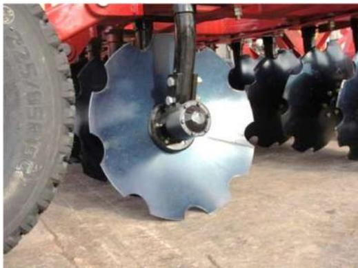
**а – регулятор угла атаки дисков; б – стойки; в – опора подшипниковая;**
