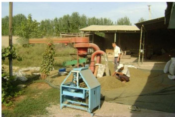
Рис. 2. Общий вид клеверотерки и сортировочного устройства в работе
