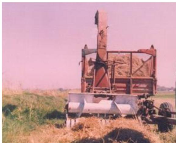
Рис. 1. Кормоуборочный комбайн Е-301 и косилка-измельчитель КПИ-2,4А в работе
