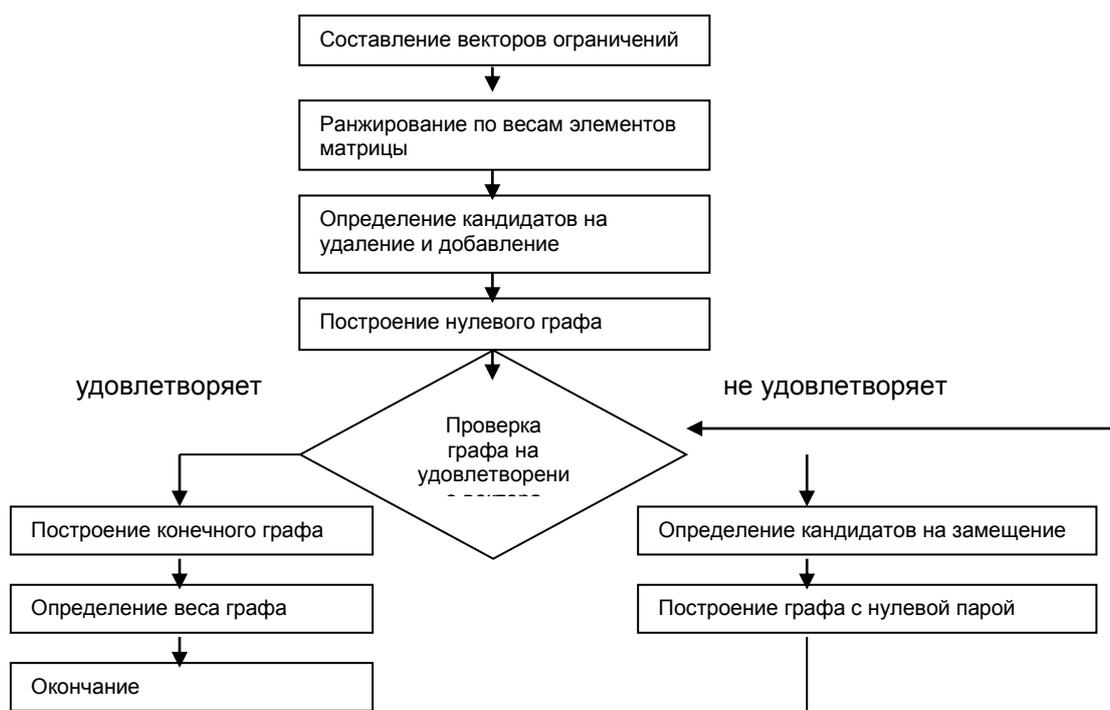
Рисунок 1. Алгоритм синтеза оптимального графа.
