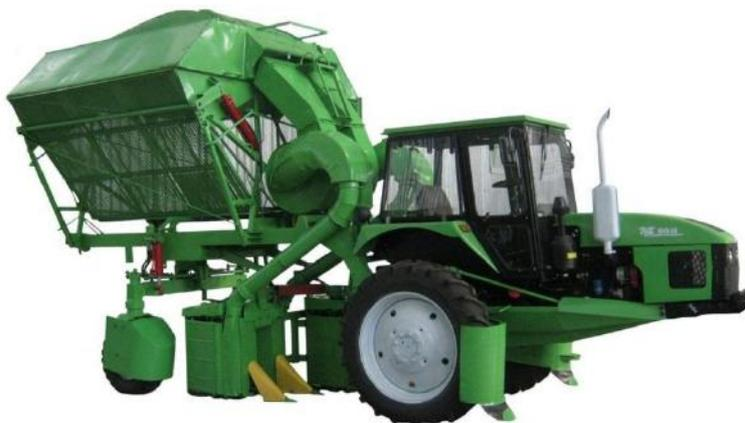
**Рис. 1. Модернизированная хлопкоуборочная машина «МХ-1,8»**
