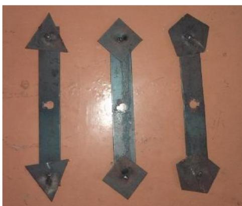
Рисунок 2. Рабочий орган дробилки с дополнительным измельчителем: а - с треугольным доизмельчителем (внутренний угол  $60^\circ$ ); б - с прямоугольным доизмельчителем (внутренний угол  $90^\circ$ ); в - с пятиугольным доизмельчителем (внутренний угол  $108^\circ$ )
