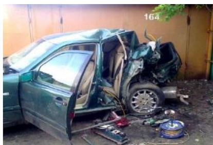
а) после ДТП. Разрушена задняя часть кузова,
